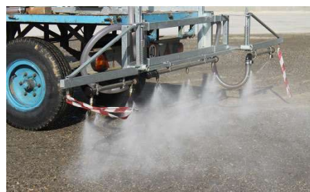
Figura 6: Esempio di un mezzo utilizzato per la bagnatura dei piazzali e delle piste
